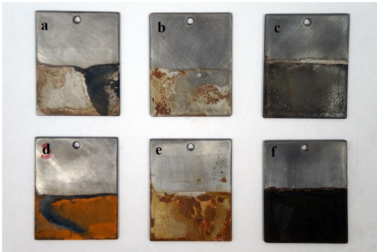
Slika 42. Makro slika površine pločica ugljeničnog čelika poslije izlaganja 0.51 \text{ mol dm}^{-3} rastvoru NaCl poslije mehaničkog čišćenja površine:
