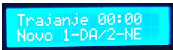
Slika 4.23 Podešavanje trajanja aktivacije ventila
