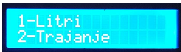
Slika 4.26 Izbor načina deaktivacije ventila: prema trajanju ili prema količini propuštene vode
