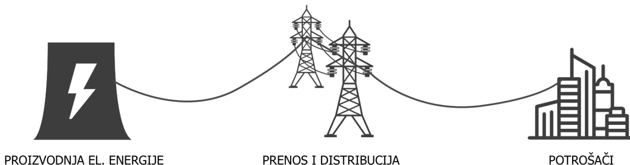
Slika 1.1 Jednosmjerni tok električne energije
