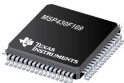
Slika 3.16 Texas Instruments-ov mikrokontroler MSP430F169
