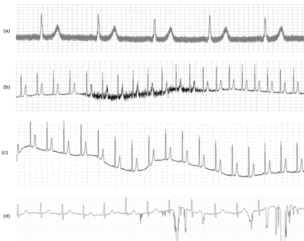
Slika 1.6 Tipovi šuma u EKG signalu : (a) elektromagnetni šum od izvora napajanja 50 Hz; (b) mišićni šum; (c) pomjeranje bazne linije; (d) artefakti pokreta
